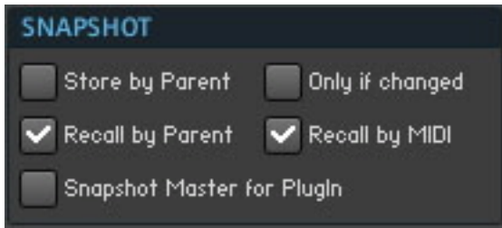
Ilust. 4.14 El área de Snapshot del cuadro de propiedades del instrumento Junatik, con la casilla "Recall by Parent" marcada.
