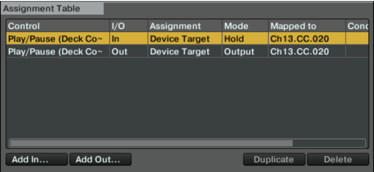
El control Play/Pause mapeado como control de entrada y de salida.
