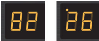
El visualizador de 7 segmentos muestra una lectura de 82 (izquierda) y de 126 (derecha).
