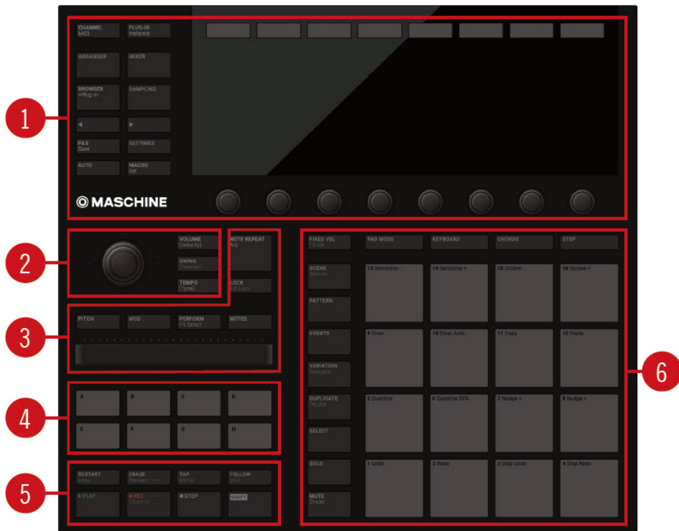
MASCHINE 控制器的前面板及其主要部份
