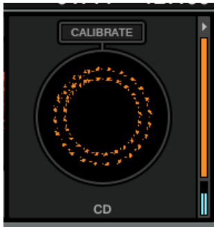
CD MK1 (la línea punteada aparece a determinadas velocidades de reproducción)
