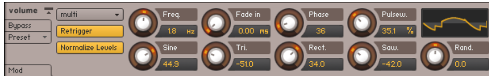
Un multi LFO que permite mezclar todas las otras ondas en una forma compleja
