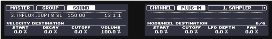
Paramètres du Sampler – Page 6 sur 6 : VELOCITY DESTINATION et MODWHEEL DESTINATION sur le contrôleur.
