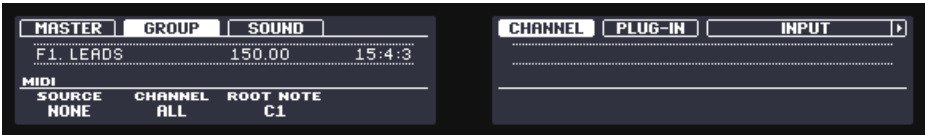
La Page MIDI des Input Properties (ici pour un Group) sur le contrôleur.
