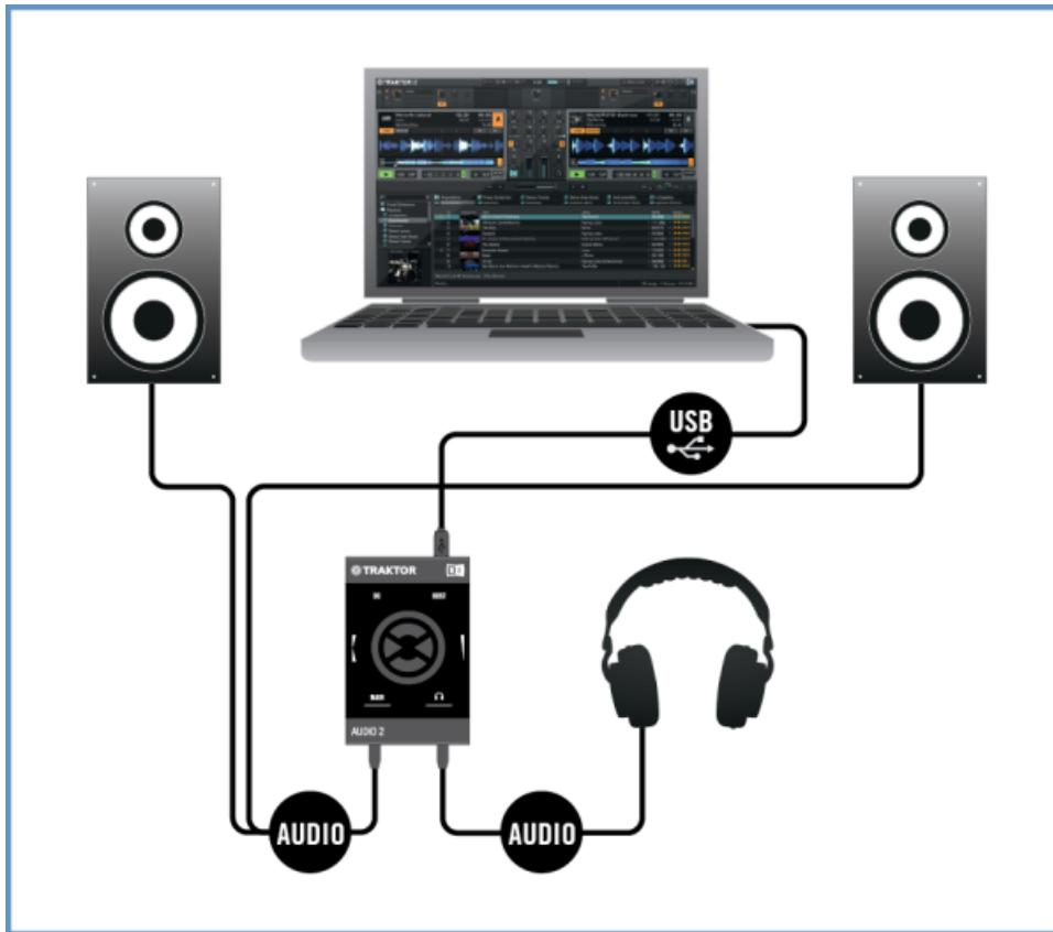
コンピューターが内部ミキサー mode の状態で TA2 を使用する場合の概観です。
