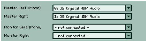
Verwenden Sie eine Onboard-Soundkarte oder eine einfache Stereo-Soundkarte sollten sie die Monitor-Kanäle unbelegt lassen.
